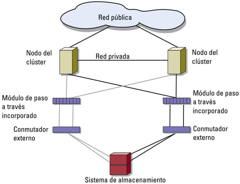
**Ilustración 1-6. Clúster de conexión mediante conmutador conectado a una SAN externa mediante módulos de conmutador incorporados**
