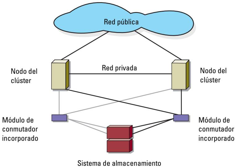
**Ilustración 1-5. Clúster de conexión mediante conmutador conectado a una SAN externa mediante módulos de paso a través incorporados**
